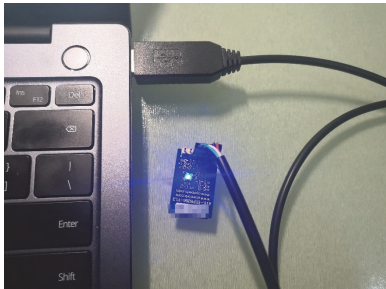
图 17-1 通过 USB 转 UART 线 连接计算机和 ESP8266 模块
